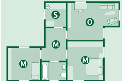
Rauchmelder müssen an der Decke in der Raummitte montiert werden. Sie gehören nicht in Räume mit Wasserdampf oder einer hohen Staubbelastung. Rauchmelder sollten im Flur in Küchentürnähe und/oder in der Küche mit Stummschaltung installiert werden.
